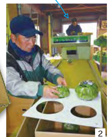
大ききの違う穴の開いた板を使ってサイズ別に分けます
