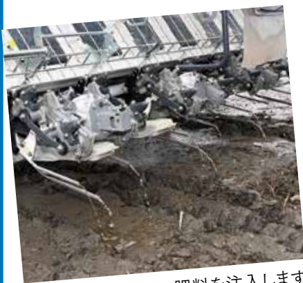
このノズルが土中へ肥料を注入します
